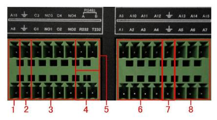
(1) (6) (8) alarm input (2) (7) ground (3) alarm output RS485(4) RS232
